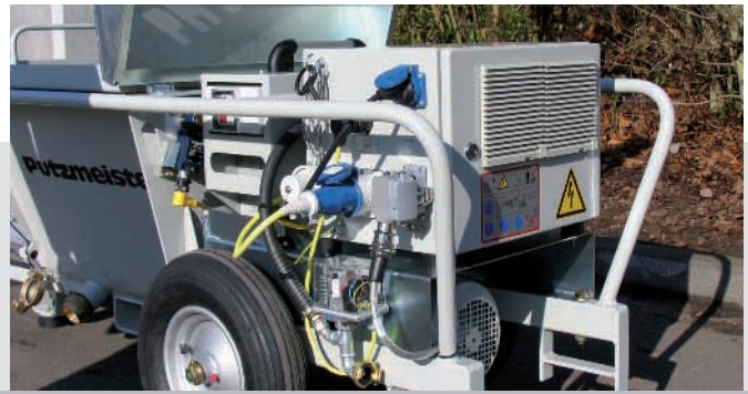
Свободный доступ к электродвигателю и компрессору. Простота снятия компрессора при необходимости.
